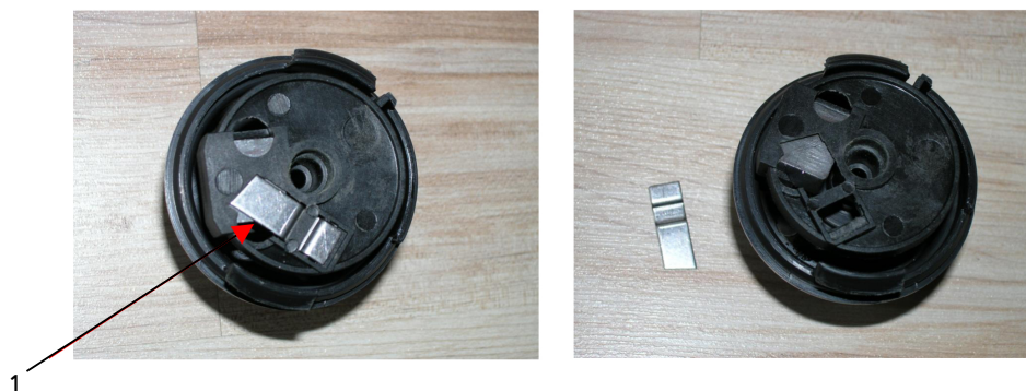
Рис. 8: Снятие стальной пластинки
