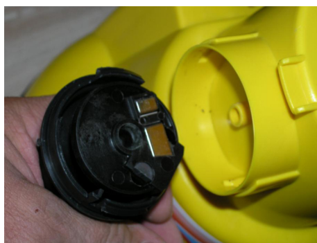
Рис. 7: Извлечение устройства автоматического переключения
