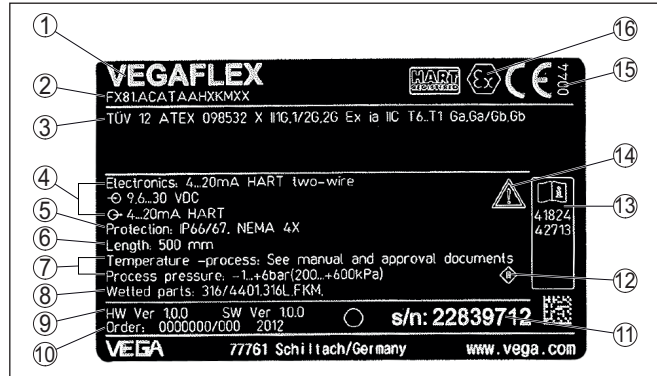
Рис. 1: Данные на типовом шильдике (пример)
