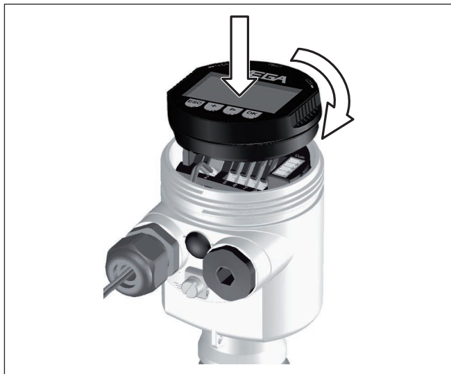
Рис. 19: Установка модуля индикации и настройки
